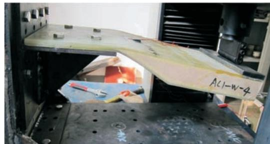
图6 连接结构变形形态
