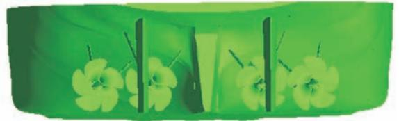
图1 螺旋桨布置示意图
