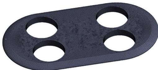
图 22 主体结构网格划分
