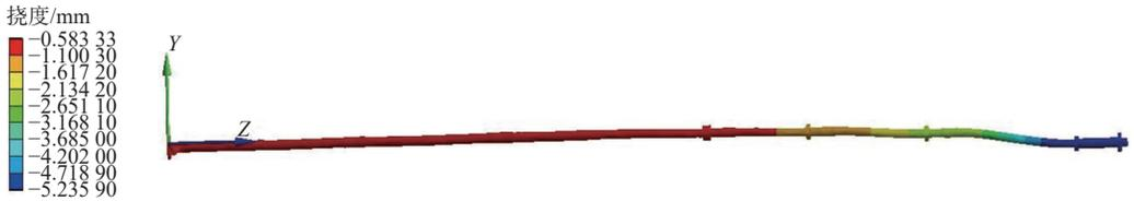
图 12 优化校中后长轴系挠度分布图
