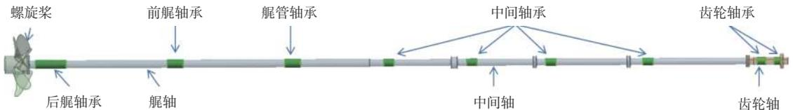
图1 某舰船长轴系布置简图
