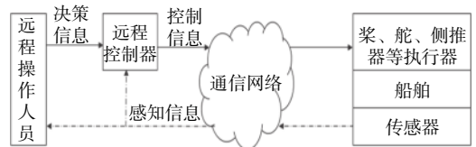
图 4 船舶网络控制系统控制逻辑 (闭环结构)
