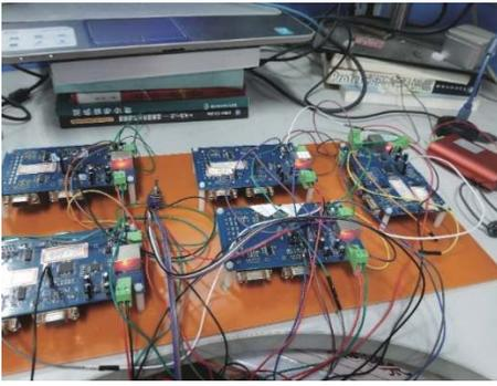
图9 NMEA2000实验模型
